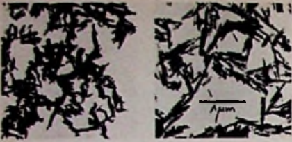
Afb. 33 Dank zij de voortdurende ontwikkeling van nieuwe bandmaterialen is de musicassette HiFi-waardig geworden. Deze met een elektronenmicroscop gemaakte foto's laten het verschil zien tussen een normale ijzeroxyde band (links) en de bijzonder fijne kristalvorm van het ijzeroxyde in de nieuwe Agfa Super Ferro Dynamic-cassette.
